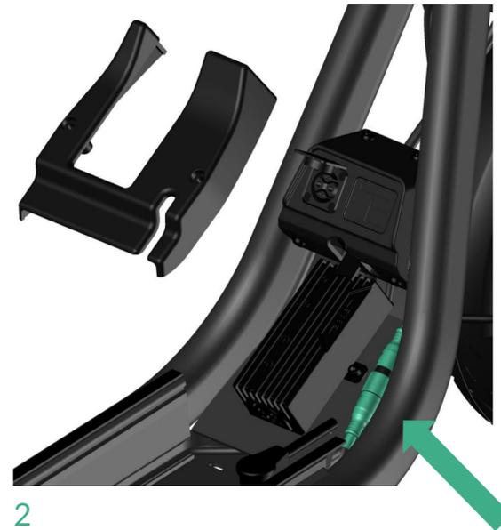
1. Entferne die Controller-Abdeckung indem du die zwei Schrauben (H3) (siehe Bild 1) löst.
